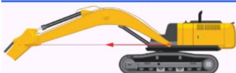
До начала работ в этой системе координат экскаватора убедитесь, что линия соединяющая центр шарнира крепления стрелы к поворотной платформе и центр шарнира крепления стрелы к рукояти лежит на прямой, параллельной горизонтальной плоскости.
